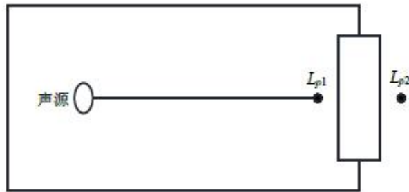
图 4-1 室内声源等效为室外声源示意图
